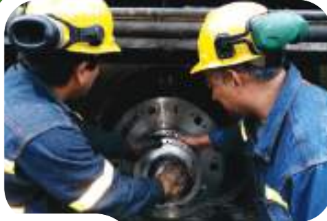
Maquinado de tuerca para rotor
